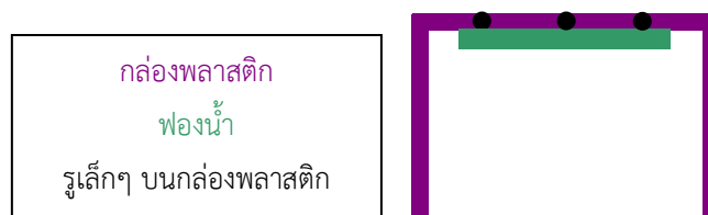
ภาพที่ 35 แสดงการจัดวางกล่องพลาสติก และ ฟองน้ำ เพื่อทำคลาวด์แชมเบอร์
